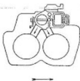
2 cilindros verticales con un carburador invertido.
