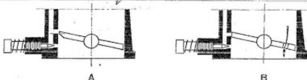
FIG. 40 En A para anticipar la intervención del taladro de progresión se hace un pequeño chafón en la mariposa. En B para retrasar la intervención de progresión se hace un pequeño taladro en la mariposa misma.
